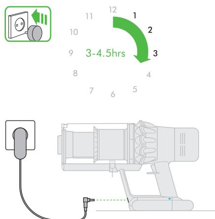
Подключите устройство непосредственно к зарядному устройству или установите его в док-станцию.
