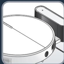
**RU** Чтобы зарядить робот, нажмите и удерживайте кнопку включения в течение 3 секунд. Поместите робот на зарядную станцию так, чтобы его контактные пластины касались клемм на зарядной станции. Возвращайте робот на зарядную станцию каждый раз после завершения использования.
