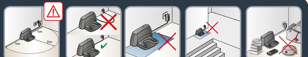
**RU** Устанавливая зарядную станцию, убедитесь, что с каждой стороны пустое пространство составляет 1 м и 2 м перед ней. Не устанавливайте зарядную станцию рядом с лестницей. Убедитесь, что кабель плотно вставлен в соответствующий разъем. Зарядная станция должна быть размещена на твердой поверхности. Не размещайте зарядную станцию на ковровых покрытиях.
