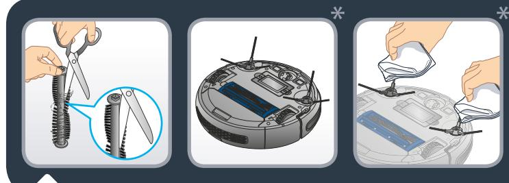
**RU** Для очистки щетки обрежьте волосы ножницами. Очищайте боковые щетки робота сухой чистой тканью.
