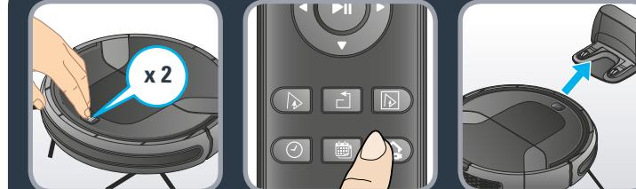
**RU** Для завершения уборки нажмите кнопку на корпусе робота или на пульте ДУ. Чтобы вернуть робота на зарядную станцию, два раза нажмите кнопку на корпусе робота или на пульте ДУ.
