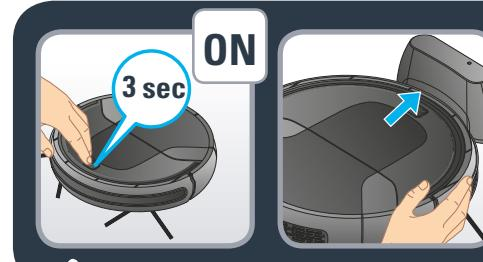
**RU** Чтобы зарядить робот, нажмите и удерживайте кнопку включения в течение 3 секунд. Поместите робот на зарядную станцию так, чтобы его контактные пластины касались клемм на зарядной станции.
