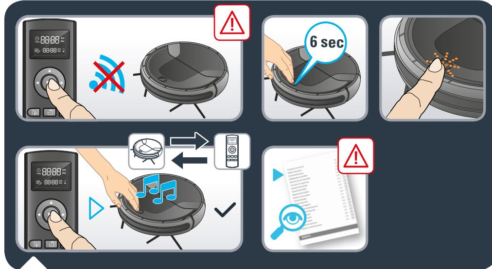
**RU** Внимание! Пульт ДУ не может подключиться к роботу автоматически, соединение нужно настроить вручную. Для этого нажмите и удерживайте в течение 6 секунд кнопку «Старт» на корпусе робота, пока она не начнет мигать оранжевым цветом.
