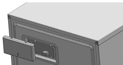
Не разрешается использовать холодильник, если на задней стенке открыта крышка с платой управления.
