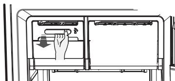
Будьте осторожны при вынимании основания ледяной формы, потому что он может внезапно сдвинуться в вашу сторону.
