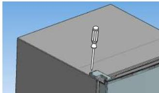
**17.** Chap tarafdag'i plastmassali qopqoq yassi kallakli (-) otvyotrka yordamida rasmda ko'satilgandek astalik bilan qopqoqni yechib oling.
