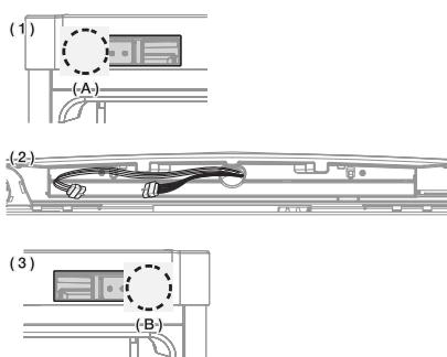
11. Після зняття кришки пульта управління (1) Замініть напрямок дверцята проводів (2) в протилежному напрямку двері холодильника (тільки для моделі з дисплеєм). Зберіть кришку управління за допомогою гвинта (A), як показано на рисунку (3).
