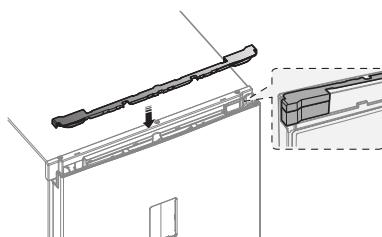
16. Змініть напрямок дверного отвору дроті в протилежний зміст і зберіть дверний проріз.
