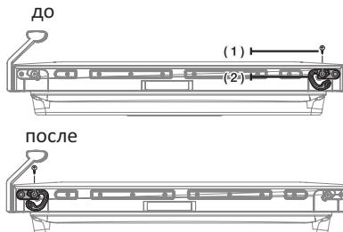
11. Установите средний кронштейн с помощью отвертки. Вначале установите дверцу холодильной камеры и средний кронштейн.
