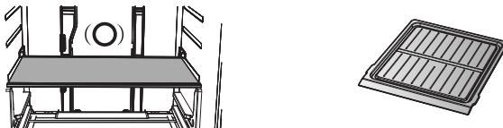
Muz qolipi va qutini chiqarib oling so'ng muz qolipi tayanchini chiqarib oling.
