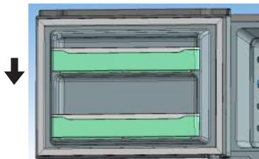
**15.** Tepa tirkakni 3 ta vint bilan otvyortka yordamida sovutgichning tepe qismiga oqotiring. Oldin sovutish kamerasingin eshigini va o'rta tirkakni yig'ing..
