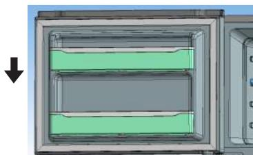
15. Закріпіти верхній кронштейн на верхній частині холодильника за допомогою викрутки і 3 гвинтів. Спочатку зберіть дверцята холодильної камери і середній кронштейн.
