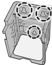
Приподнимите немного полку морозильной камеры и сдвиньте ее вперед, затем вытащите ледянную форму и коробку. Выньте основание ледяной формы.
