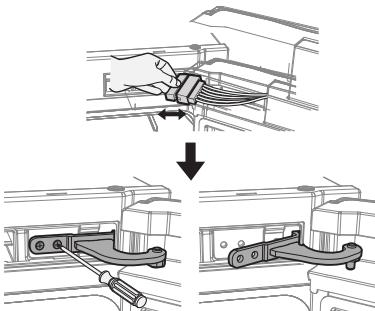
4. Сниміть дверцята холодильника з середнього шпинделя, повільно піднімаючи її вгору по вертикалі. Двері важка, тому будьте обережні, щоб не травмуватися, коли ви знімаете двері
