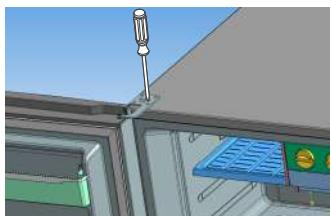
16. Встановіть верхню ковпачок кронштейна холодильника на кронштейн і закріпіть кришку за допомогою гвинта і хресний (+) викрутки.
