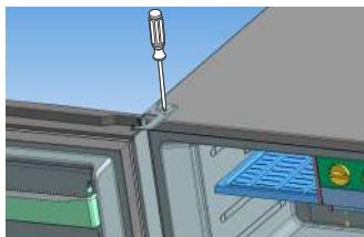
16. Установите верхнюю колпачок кронштейна холодильника на кронштейн и закрепите крышку с помощью винта и крестовой (+) отвертки.
