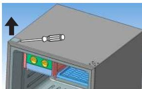
5. Отделите средний кронштейн, не отпуская 3 винта с помощью плоской отвертки.
