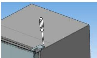
2. Затем с помощью крестовой (+) отвертки открутите 3 винта верхнего кронштейна и снимите верхний кронштейн.
