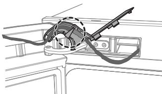
14. Подключите провод и установите его на крышку провода управления, затем поверните фиксатор, обеспечивая его соединение, как показано на рисунке ниже.
