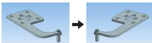
**13.** Sovutgich kamerasi eshigini pastki tirkakka o'rnatting. Keyin o'rta tirkakni vintlar bilan qotiring.
