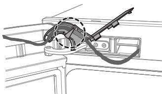
14. Підключіть провід і встановіть його на кришку дроті управління, потім поверніть фіксатор, забезпечуючи його з'єднання, як показано на малюнку нижче.
