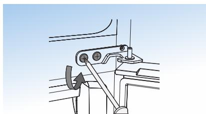
6. Поднимите дверцу холодильной камеры вертикально вверх, чтобы вытащить ее из нижнего кронштейна.
