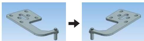
13. Установите дверцу холодильной камеры на нижний кронштейн. Затем закрепите средний кронштейн винтами.
