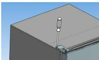
17. С помощью плоской (-) отвертки снимите пластмассовую крышку с подкладкой, как показано на рисунке.
