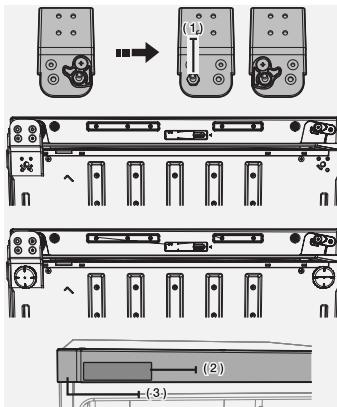
10. Замените нижний кронштейн и положение ножки (справа → налево). После установки дверцы морозильной камеры на средний кронштейн, соберите нижний кронштейн. Снимите держатель колеса и стрелку колеса (1). Установите стрелку и держатель колеса так, как показано на этом рисунке. Снимите крышку пульта управления (3) с крышки пульта управления (2), как показано на рисунке.
