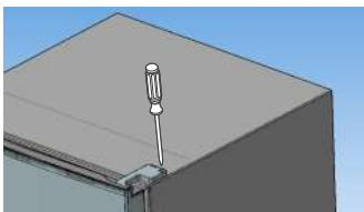
2. Потім за допомогою хрестової (+) викрутки відкрутіть 3 гвинта верхнього кронштейна і зніміть верхній кронштейн.
