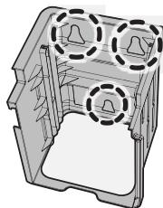
Muzlatish kamerasi tokchasini ozgina ko'tating va uni oldinga suring, so'ng muz qolipi va qutini chiqarib oling. Muz qolipi tayanchini chiqarib oling.
