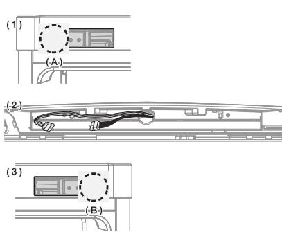
11. После снятия крышки пульта управления (1) Замените направление дверцы проводов (2) в противоположном направлении двери холодильника (только для модели с дисплеем). Соберите крышку управления с помощью винта (A), как показано на рисунке (3).
