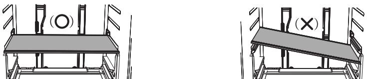
При снятии полок холодильника, если есть возможность открыть дверь, потяните полки вперед, слегка приподняв ее, чтобы вынуть.
