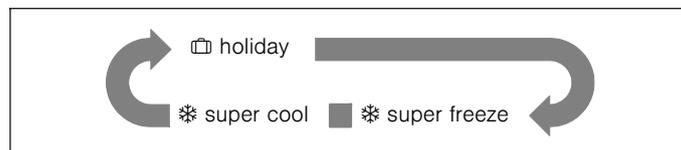
После выбора определённого режима работы подождите, пока в течение 10 секунд не начнёт мигать соответствующий индикатор. Затем два раза прозвучит зуммер и индикатор загорится на длительное время. Функция активна.
