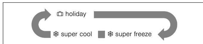
После выбора определённого режима работы подождите, пока в течение 10 секунд не начнёт мигать соответствующий индикатор. Затем два раза прозвучит зуммер и индикатор загорится на длительное время. Функция активна.
