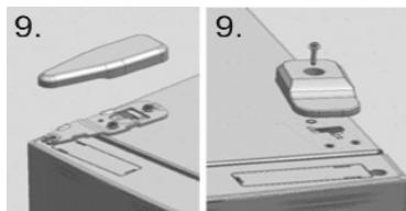
8) Установите холодильную дверь, затем закрепите верхнюю петлю в верхнем левом углу шкафа.
