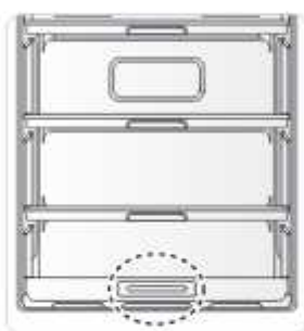
Крышка фильтра-поглотителя запаха в верхней камере
