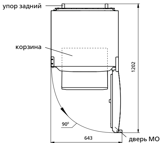
Рисунок 2 – Холодильник (вид сверху)
