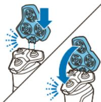
Примечание. При установке бритвенных головок и присоединении фиксирующих колец удерживайте держатель бритвенных головок в руке. Не оставляйте держатель бритвенных головок на рабочей поверхности во избежание их повреждения.
