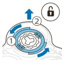
**3** Поверните фиксирующие кольца против часовой стрелки и снимите их. Поместите их в безопасное место.
