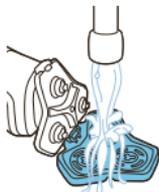
**5** Промойте держатель бритвенных головок под струей теплой водопроводной воды.
