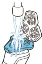
**4** Промойте отсек для сбора волос под струей теплой водопроводной воды.
