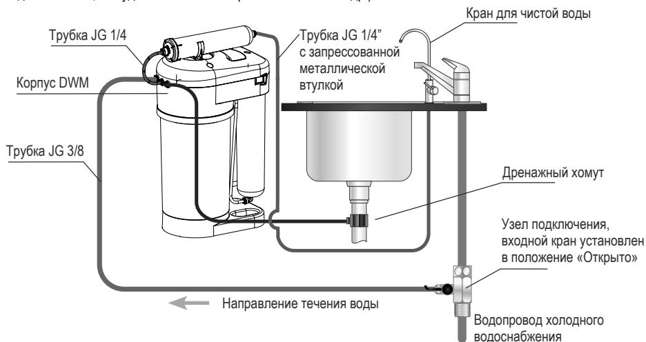
Установка узла подключения\* (рис.3)
