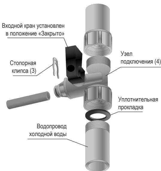
Рис. 3. Схема установки узла подключения
