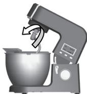
6. Отсоедините установленную насадку (венчик, плоскую насадку или крюк), повернув ее против часовой стрелки.
