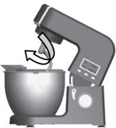
3. Установите необходимый аксессуар (венчик, плоскую насадку или крюк) на валик мотора во внутренней стороне поворотного кронштейна. Зафиксируйте насадку, повернув ее по часовой стрелке.
