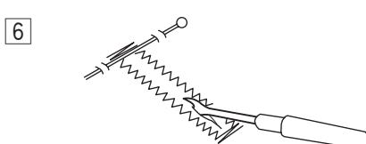
⑥ Поднимите прижимную лапку и снимите ткань. Обрежьте обе нити, оставив по 10 см от конца. Выведите игольную нить на изнанку, потянув за шпульную нить. Завяжите нити. Вставьте булавку внутри поперечины. Прорежьте петлю вспарывателем. Будьте внимательны, не разрежьте стежки.
