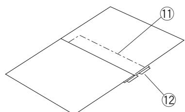
1 Пристегните лапку для втачивания молнии на правую часть перекладины. Заложите назад верхний слой ткани на припуск. Затем заложите нижний слой ткани, оставив 0.4 см до края ткани.
