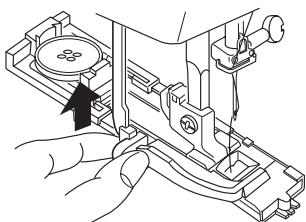
Чтобы сделать петлю такого же размера, верните регулятор выбора строчек на «RESET», затем обратно на «» как показано на рисунке.
