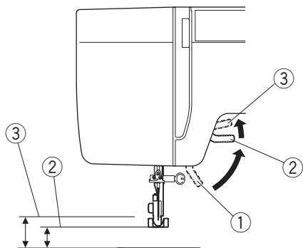
Рычаг подъёма прижимной лапки поднимает и опускает прижимную лапку.
