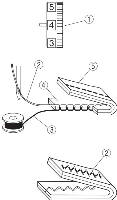
Натяжение нити при шитье устанавливается в зависимости от обрабатываемой ткани, количества слоёв и других различных условий. Для изменения натяжения нити поверните диск натяжения нити.
