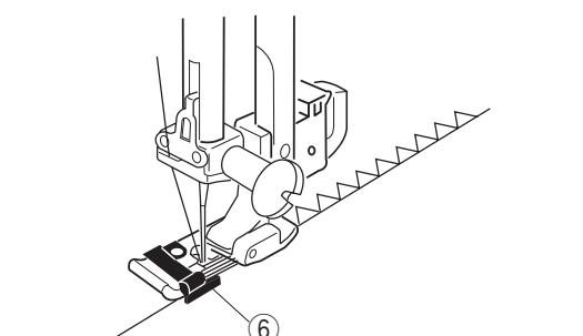
Этим стежком обрабатывается край материала для предотвращения осыпания нитей. Его можно использовать для завершения шва.
