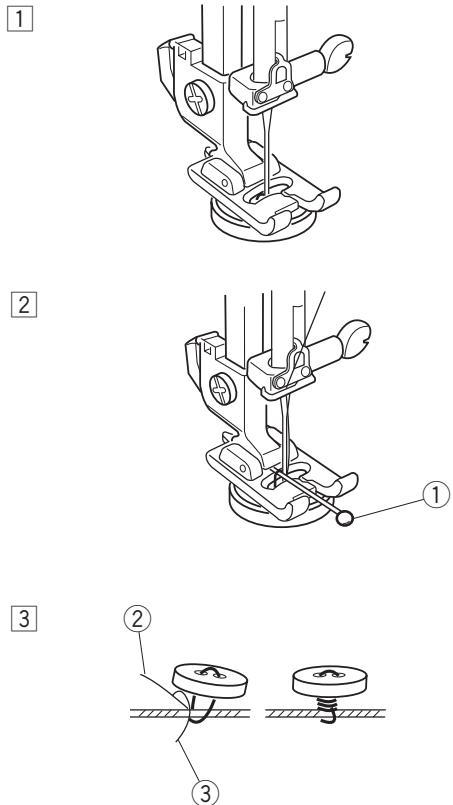
1 Удалите нить из иглы. Измените ширину зигзага так, чтобы игла сквозь прорезь на лапке попадала в отверстия пуговицы. Поверните маховое колесо и проверьте, входит ли игла в отверстия пуговицы. Опустите прижимную лапку, чтобы закрепить пуговицу на месте. Отверстия в пуговице должны совпадать с прорезью на лапке.
