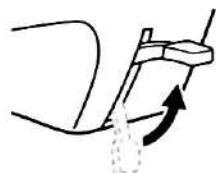
3. Поднимите подъемный рычаг прижимной лапки.
