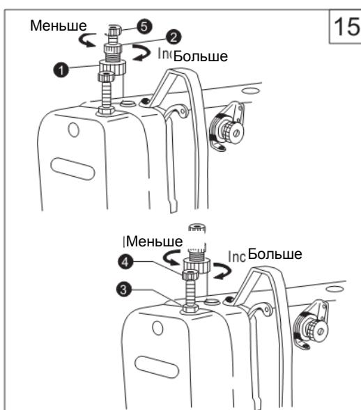
**17. Регулировка давления прижимной лапки (Рис.15)****<Регулировка давления прижимной лапки>**
