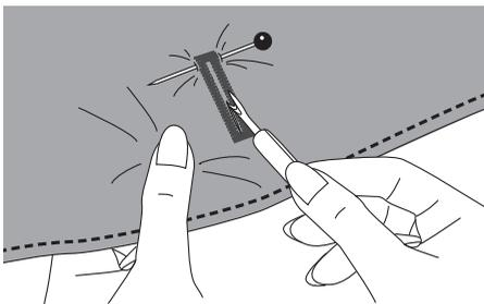
Прорежьте петлю по центру с помощью распарывателя с максимальной осторожностью, чтобы не повредить строчку с обеих сторон. Чтобы не сделать слишком длинный разрез, вставьте булавку под закрепкой петли.
