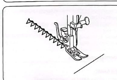
Если подача ткани вперед или назад становится несбалансированной из-за типа ткани, отрегулируйте баланс при помощи регулятора длины стежка:
