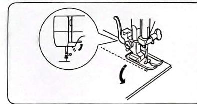
1 Поднимите прижимную лапку и расположите ткань в соответствии с направительными линиями на игольной пластине.
