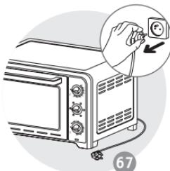
\*\* Plat non fourni avec l'appareil - Schaal niet bij het apparaat inbegrepen - Platte nicht im Lieferumfang inbegriffen - The dish is not supplied with the appliance - El plato no es suministrado con el aparato - Piatto non fornito con l'apparecchio - Travessa não fornecida com o aparelho - Блюдо не входит в комплект - Құрылымы мен бірке тарелке қамтамасыз етпілемейді - Блюдо не входит в комплект поставки приладу
