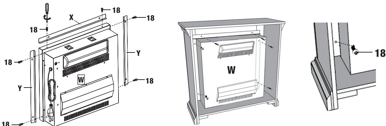
Установка каминной топки : осторожно установите каминную вставку (W) внутри камина и поставьте ее в соответствии с отверстиями. Будьте осторожны, чтобы не поцарапать обрамление. Проверьте, выровняйте, а затем прикрепите каминную топку (W) к каминной полке, вставив винты (18) через просверленные отверстия на планках (X и Y)
