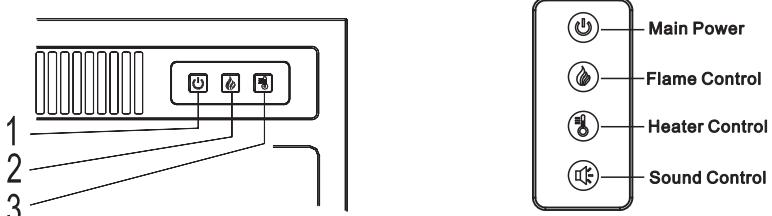
Панель управления электрокамина располагается в правом верхнем углу электрокамина. На панели управления расположены кнопки включения/выключения, контроля яркости пламени, включения/выключения нагревательного элемента.
