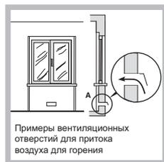
Приток воздуха может обеспечиваться непосредственно снаружи здания через воздуховод полезным сечением не менее 100 см² и диаметром, исключающим возможность случайного засорения.
