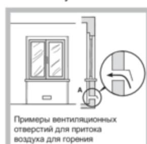
Приток воздуха может обеспечиваться непосредственно снаружи здания через воздуховод полезным сечением не менее  $100 \text{ см}^2$  и диаметром, исключающим возможность случайного засорения.
