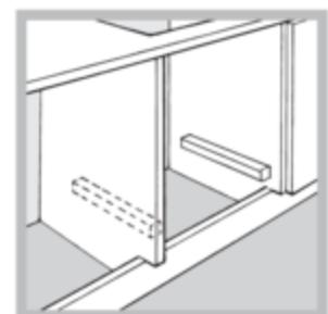
عند تركيب رف فوق الفرن بدون نظام تبريد للتهوية، فإنه يجب توفير تهوية مناسبة داخل الخزانة عن طريق فتحات للتهوية يمكن للهواء أن يمر الهواء من خلالها (انظر الرسم).
