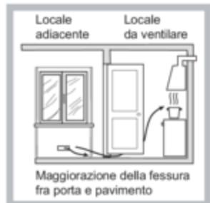
Ovvero, in maniera indiretta da locali adiacenti, dotati di un condotto di ventilazione con l'esterno come sopra descritto, e che non siano parti comuni dell'immobile, o ambienti con pericolo di incendio, o camere da letto.
