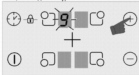
4. Когда конфорка достигнет уровня "9", прикоснитесь один раз к кнопке "(+)", чтобы установить температуру конфорки на "P".
