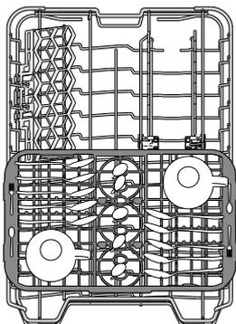
Верхняя корзина оснащена выдвижным лотком, который может использоваться для размещения мелкой посуды и столовых приборов. Для повышения качества мойки не размещайте крупную посуду непосредственно под лотком. Лоток является съемным.
