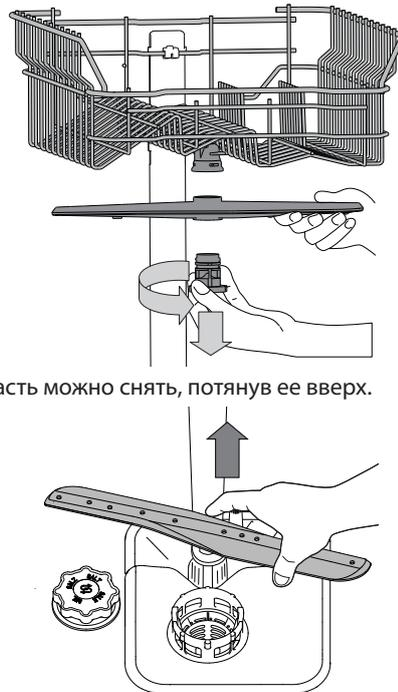
Нижнюю лопасть можно снять, потянув ее вверх.
