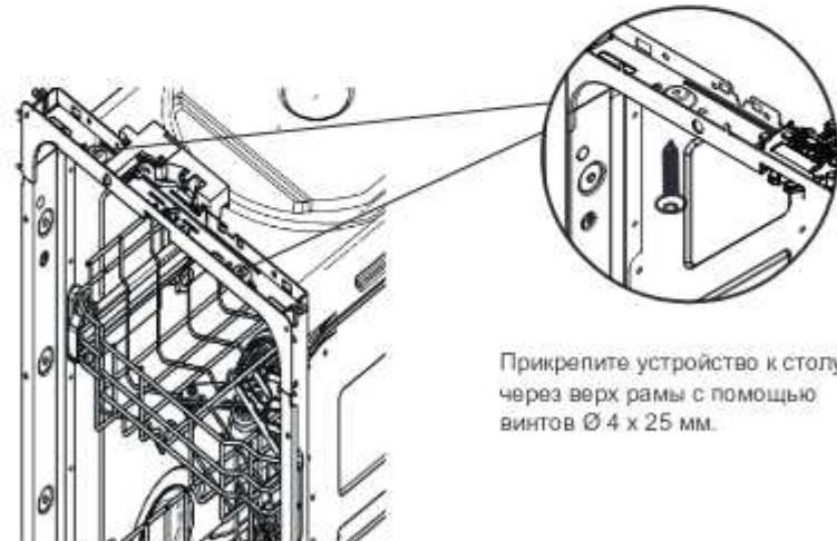
Прикрепите устройство к столу через верх рамы с помощью винтов Ø 4 x 25 мм.
