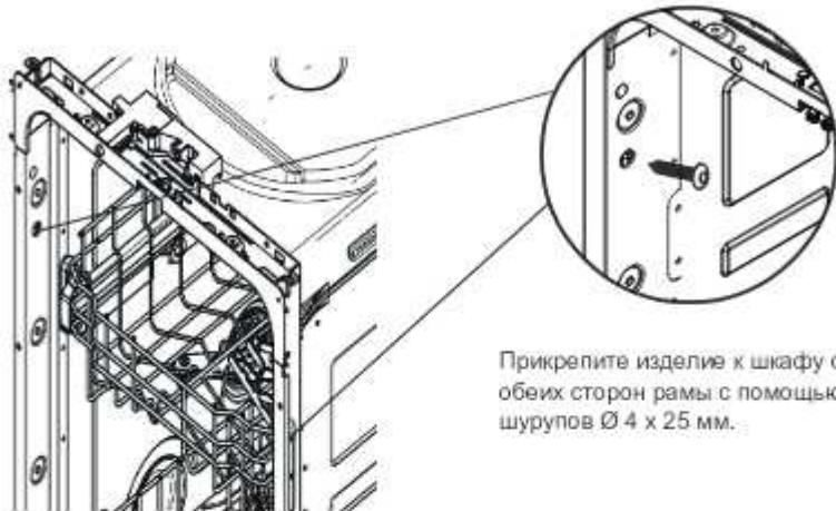
Прикрепите изделие к шкафу с обеих сторон рамы с помощью шурупов Ø 4 x 25 мм.
