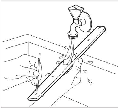
5. Для установки разбрызгивателя на место установите фиксатор в разбрызгиватель и закрепите его на трубе подачи воды, повернув по часовой стрелке. Убедитесь, что фиксатор защелкнулся.
