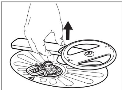
2. Промойте разбрызгиватель под струей воды. Для прочистки отверстий от частиц грязи воспользуйтесь заостренным предметом (например, зубочисткой).
