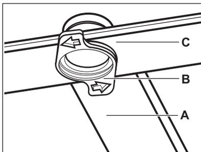
1. Снимите ограничители с боковых сторон направляющий лоток для столовых принадлежностей и выньте лоток.
