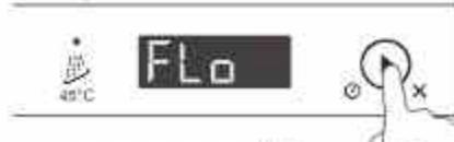
4. Коснитесь для переключения между FLo (напольный свет включен) и FL- (напольный свет выключен)
