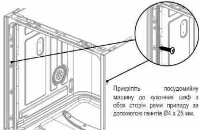
Прикріпіть посудомийну машину до кухонних шаф з обох сторін рами приладу за допомогою гвинтів Ø4 x 25 мм.
