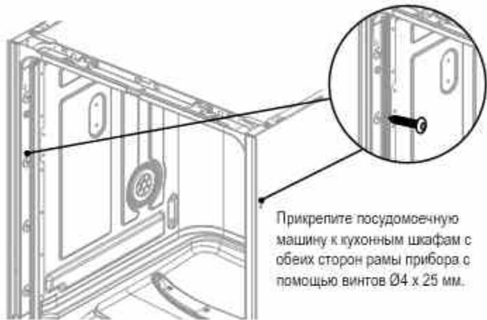
Прикрепите посудомоечную машину к кухонным шкафам с обеих сторон рамы прибора с помощью винтов Ø4 x 25 мм.
