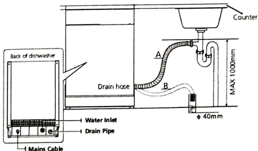
Перевод слева-направо сверху-вниз: задняя часть посудомоечной машины / кабель питания / подвод воды / сливная труба / сливной шланг / 40 мм / максимум 1000 мм / столешница
