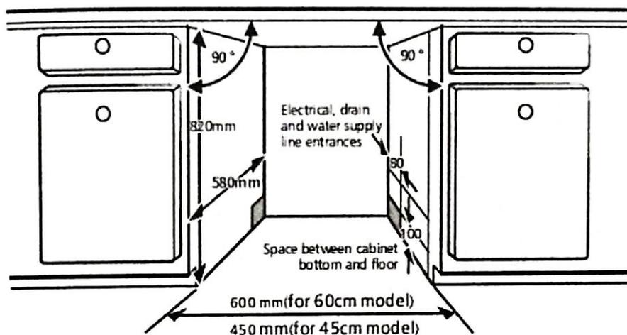
Перевод слева-направо сверху-вниз: 820 мм / 580 мм / 600 мм (для 60см модели) / 450 мм (для 45 см модели) / выходы для электричества, слива и подачи воды / пространство между нижней частью шкафа и полом
