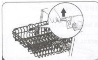
2 Чтобы опустить верхнюю корзину, поднимите регулировочные ручки с каждой стороны, чтобы освободить корзину, и опустите ее в нижнее положение.
