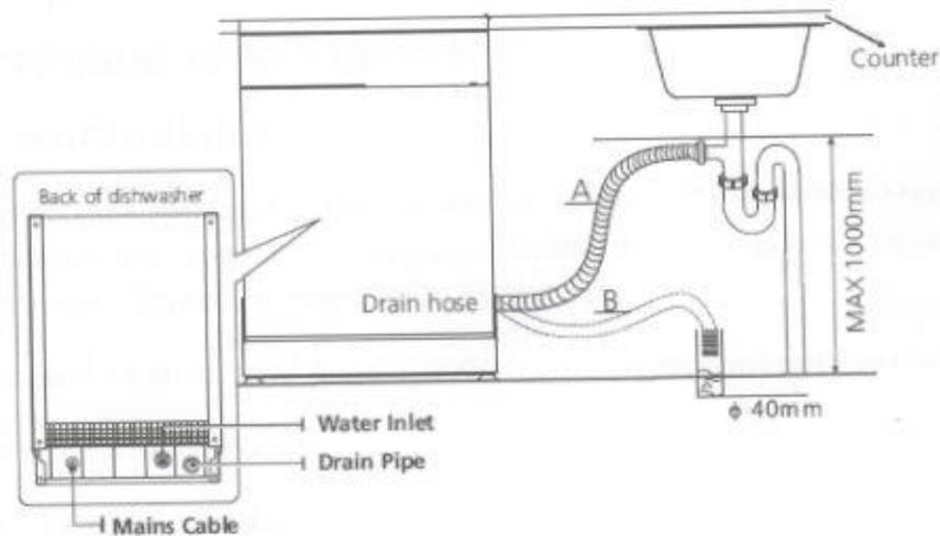
*Перевод слева-направо сверху-вниз: задняя часть посудомоечной машины / контур питания / подвод воды / сливная труба / сливной шланг / 40 мм / максимум 1000 столешница*
