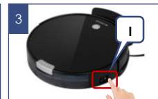
I/O ауыстырып-қосқышын «I» жайғасымға ауыстырыңыз.
