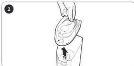
Changquti qopqog'idagi kertikni ushlab, tortib chiqaring.
