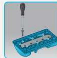
**FR** Retirer la lingette. Vider le réservoir d'eau. Enlever les 8 vis du système de distribution d'eau, remplacer le ressort et le système de distribution d'eau, revisser le système de distribution d'eau au réservoir.
