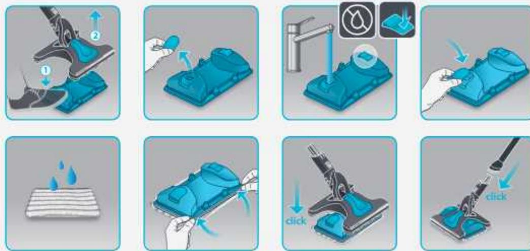
**FR** **Rémpissage :** Détachez le réservoir d'eau de la tête de nettoyage. Retirez le bouchon et remplissez le réservoir d'eau\* en position inclinée avec la pédale en position « **goutte barrée** ». Refermez le bouchon une fois le remplissage terminé. Humidifiez légèrement la lingette avant de la placer sur le réservoir d'eau et replacez le réservoir d'eau sur l'appareil. Branchez la tête sur le corps de l'appareil.
