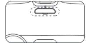
提示：確保將靜電標籤粘貼在擋風玻璃的平坦部分之上，用力按壓，並避免將其粘貼在擋風玻璃薄膜的邊緣，以防掉落。
