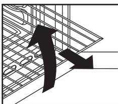
Духовой шкаф оборудован системой безопасности полок. Она позволяет выдвигать полку для проверки блюда без риска его соскальзывания или случайного выпадения полки из духового шкафа. Чтобы полностью вынуть полку потяните её к себе и вверх.
