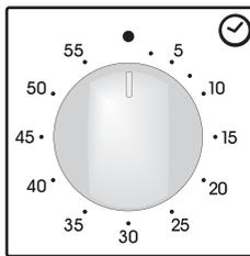
Для установки времени приготовления совместите указатель ручки с требуемым временем, по истечении установленного периода в течение нескольких минут будет звучать звуковой сигнал.
