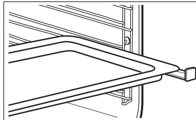
**Одновременная установка решетки и эмалированного противня:**
