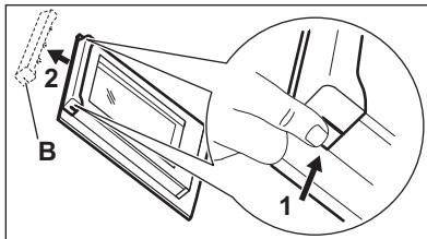
Возьмитесь за дверную планку (B) на верхней кромке дверцы с двух сторон и нажмите внутрь, чтобы освободить защелку.
