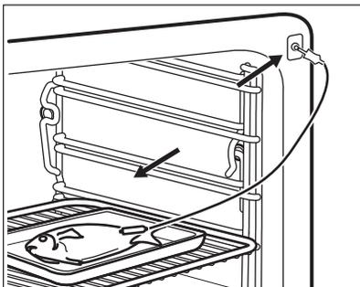
Вставьте наконечник Термощуп точно в центр запеканки. Во время запекания Термощуп не должен менять своего положения в блюде. Для этого зафиксируйте его при помощи одного из более твердых ингредиентов. Для фиксации силиконовой ручки Термощуп воспользуйтесь краем посуды, в которой производится запекание. Наконечник Термощуп не должен касаться дна посуды для запекания. Выложите поверх Термощуп другие ингредиенты.
