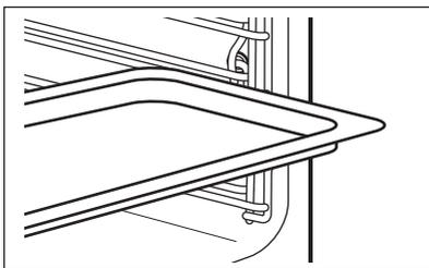
**Одновременная установка решетки и эмалированного противня /сотейника:**
