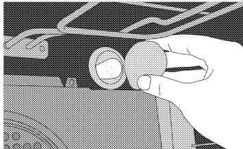
3. Выверните лампочку освещения духовки, поворачивая ее против часовой стрелки, и установите на ее место новую.
