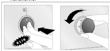
2. После окончания приготовления пищи поверните ручку в положение отключения (вверх) и прижмите, чтобы она вошла внутрь.
