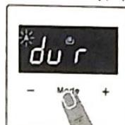
2. Экранда «dur» таңбасы пайда болғанша «MODE» түймесін басыңыз. «A» таңбасы жыпылықтайды.
