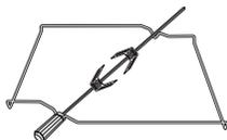
**Жарочный вертел (поставляется дополнительно)**, 2 вилки, съемная ручка и подставка, которая устанавливается на 3-й уровень снизу. При использовании вертел необходимо вставлять в отверстие в задней внутренней стенке духового шкафа. При жарке на вертеле поместите глубокую сковороду на 1-й уровень.
