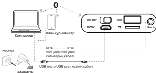
2-сурет. Қосылу схемасы
