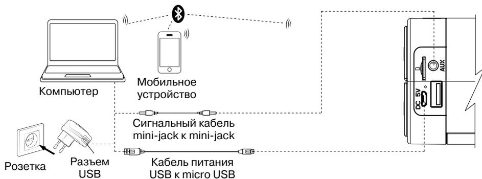
Рис. 2. Схема подключения
