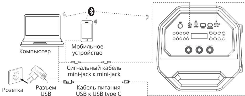
Рис. 3. Схема подключения
