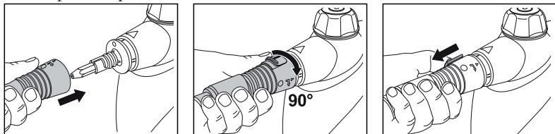
Чтобы снять паровой шланг потяните фиксатор на себя и одновременно поверните паровой шланг на  $90^\circ$  против часовой стрелки, и снимите его, как показано на рисунке.
