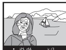
Режим зоны АФ можно выбрать, нажав кнопку режима АФ и поворачивая вспомогательный диск управления то тех пор, пока желаемая настройка не отобразится в видоискателе или на панели управления.
