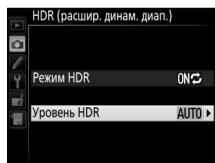
Выделите **AUTO Авто**, **HIGH\* Сверхусиленный**, **HIGH Усиленный**, **NORM Нормальный** или **LOW Умеренный** и нажмите **OK**. Если выбрано **AUTO Авто**, фотокамера автоматически отрегулирует уровень HDR в соответствии с условиями съемки.
