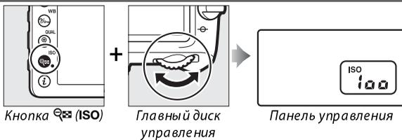
Установите автоматическое управление чувствительностью ISO (□ 82).
