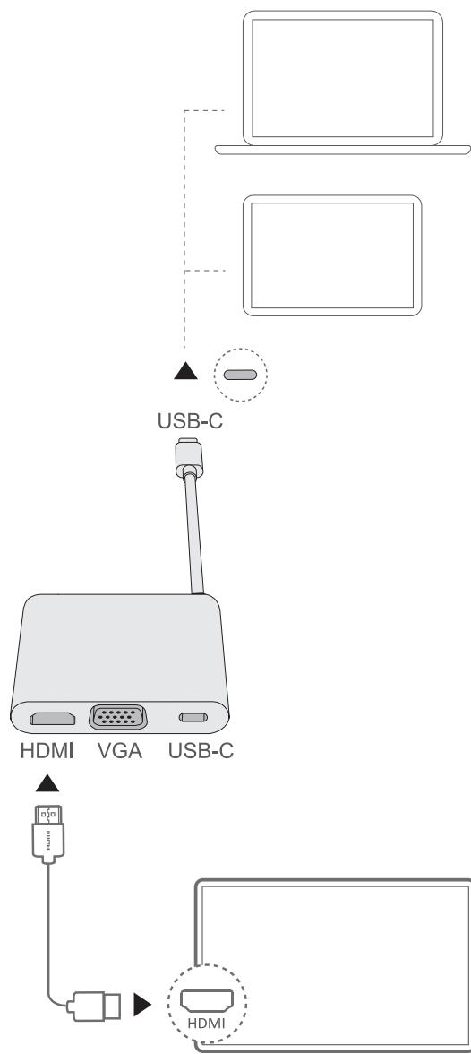
**1** Подключите компьютер к телевизору, монитору или проектору с помощью док-станции MateDock, как показано на рисунке.
