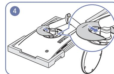
На задней панели монитора, выровняйте и введите ВЕРХНЮЮ КРЫШКУ ЗАДНЕЙ ПАНЕЛИ в паз в направлении, указанном стрелкой.
