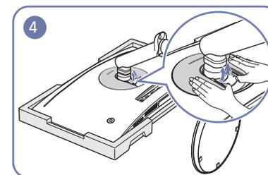
На задней панели монитора, поднимите ВЕРХНЮЮ КРЫШКУ ЗАДНЕЙ ПАНЕЛИ пальцами в направлении, указанном стрелками, как показано на рисунке.
