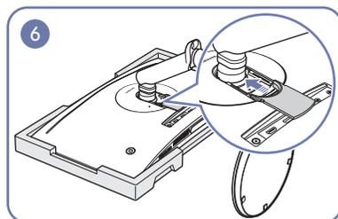
На задней панели монитора, выровняйте и введите НИЖНЮЮ КРЫШКУ ЗАДНЕЙ ПАНЕЛИ в паз в направлении, указанном стрелкой.
