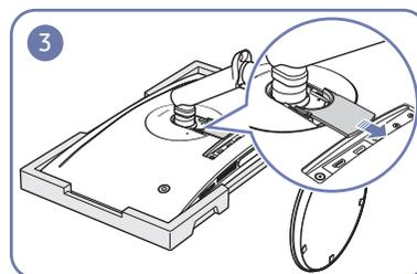
Снимите НИЖНЮЮ КРЫШКУ ЗАДНЕЙ ПАНЕЛИ в направлении, указанном стрелкой.
