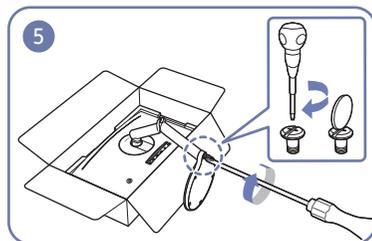
Прикрепите основу подставки к ее шейке, затем закрепите два винта на основе, чтобы плотно зафиксировать ее.
