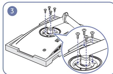
Используйте винты на подставке для плотного закрепления.
