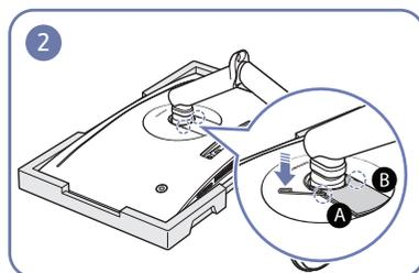
Вставьте специальный монтажный штифт в петельки **A** и **B**, а затем используйте штифт в качестве рычага для подъема НИЖНЕЙ КРЫШКИ ЗАДНЕЙ ПАНЕЛИ.
