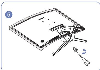
Закрепите соединительную часть на экране двумя винтами.
