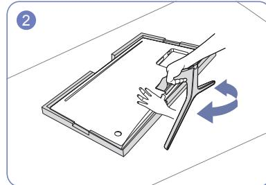
Чтобы отсоединить подставку от монитора, обязательно нажмите на нижнюю часть монитора одной рукой и потяните подставку другой рукой из стороны в сторону другой рукой, чтобы создать некоторый зазор между ними.
