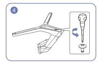
Открутите соединительный винт в нижней части подставки.
