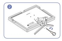
Открутите винты в нижней части соединительного элемента.
