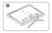
Положите на пол защитный пенопластовый материал (стирофом), входящий в комплект, и разместите на нем устройство экраном вниз, как показано на рисунке.
