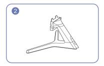
Проверьте, надежно ли закреплен соединительный элемент подставки.
