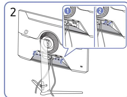
Расположите кабели, учитывая сгибающую способность, и извлеките кабели из НИЖНЕЙ КРЫШКИ ЗАДНЕЙ ПАНЕЛИ.
