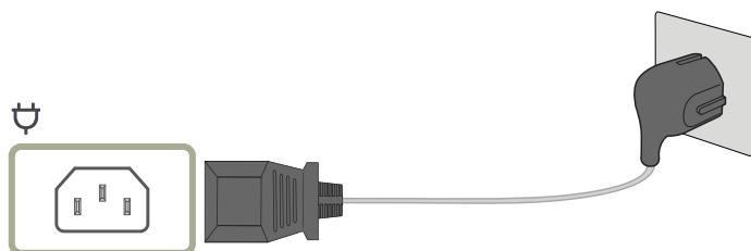
Для работы с устройством подключите кабель питания к электрической розетке и порту
