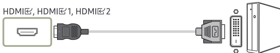
— Функция воспроизведения звука не поддерживается, если устройство подключается с помощью кабеля HDMI-DVI.
