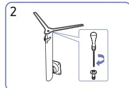
Полностью закрутите соединительный винт в нижней части подставки, чтобы как следует зафиксировать соединительный элемент. Затяните большой винт в середине, чтобы собрать конструкцию вместе.
