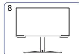
После подсоединения подставки установите устройство в вертикальное положение.
