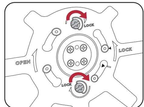
Совместите кронштейн стойки с монитором и затем сдвиньте их, чтобы они со щелчком вошли в зацепление друг с другом.
